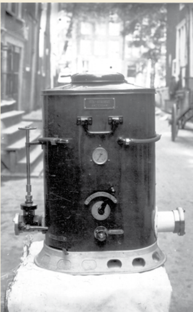
Schuimblussing anno 1929: schuimpoeder in een trechter en de goede mengverhouding inschatten gaf het gewenste schuim.
