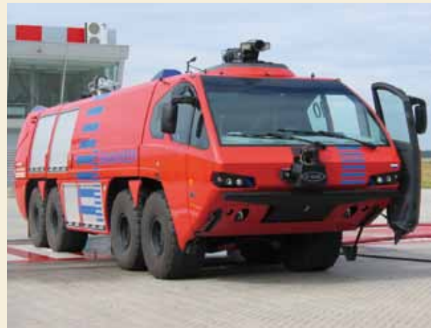
De modernste vorm van giga-blussers zijn de crashtrucks van het soort dat op Schiphol rondrijdt met snelheden van 120 kilometer per uur.
