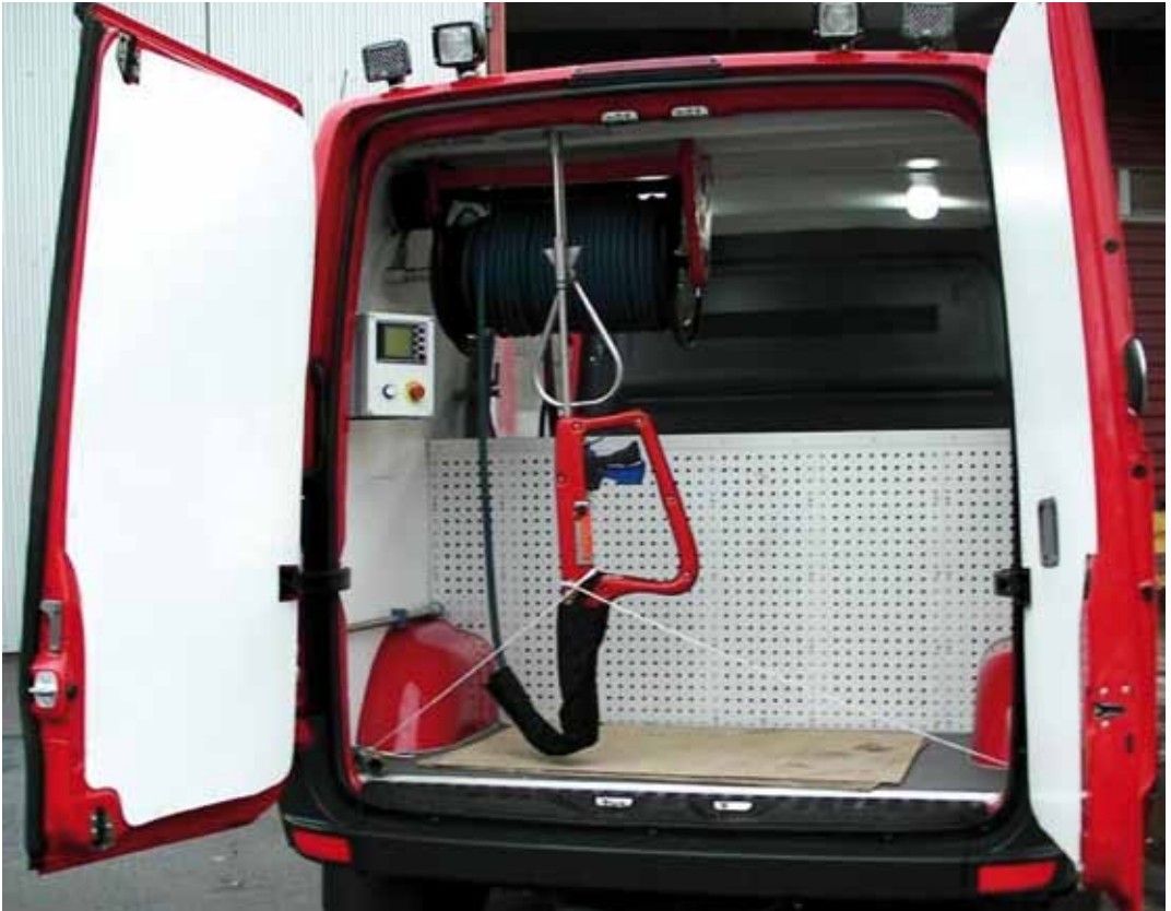
De Cobra coldcutter, waarmee het mogelijk is om door materiaal heen te snijden en daarna een mist van heel fijne waterdruppels op de brandhaard te spuiten
