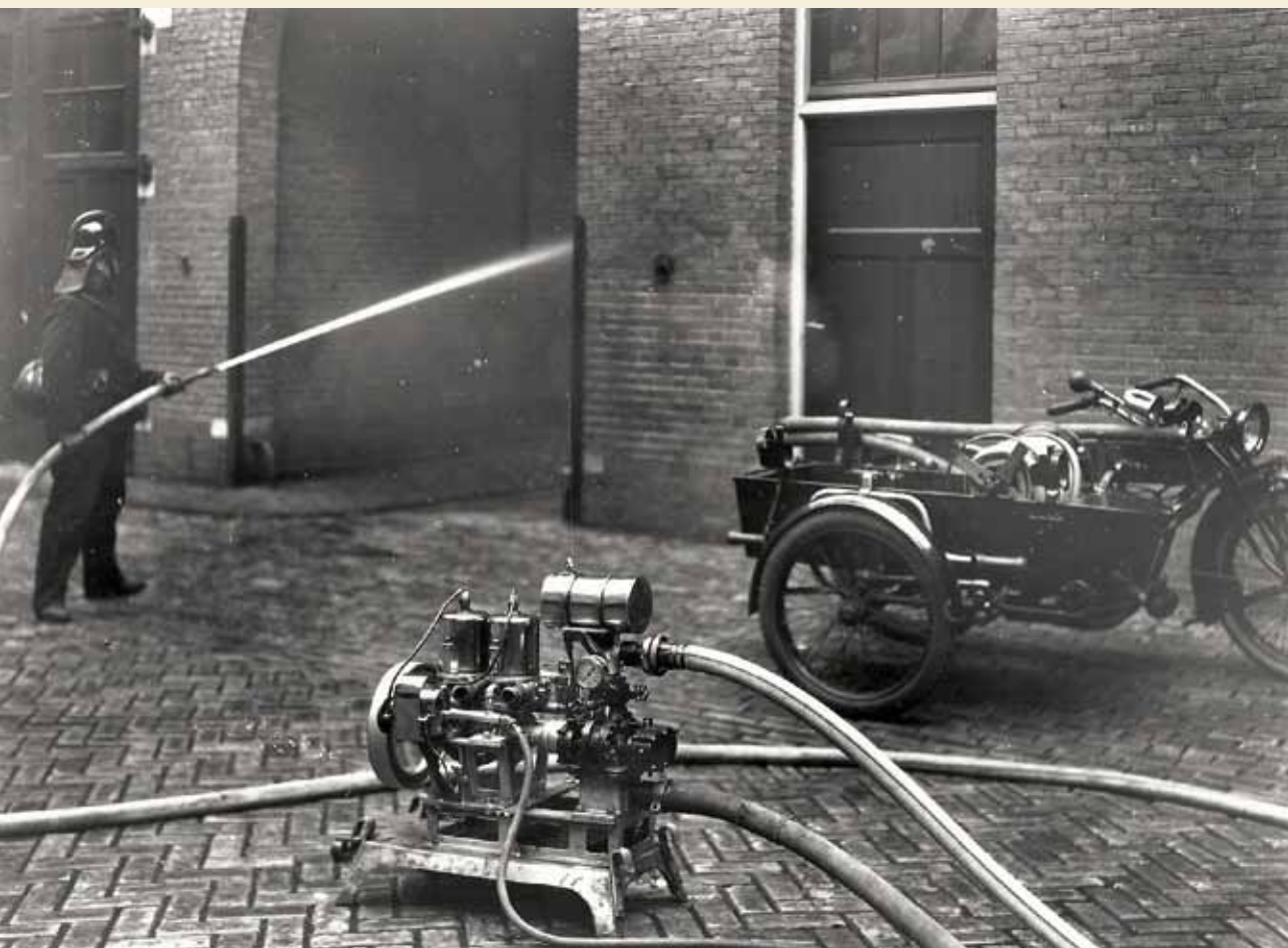
De eerste echte baby-motorspuit in Europa in een motorzipspan oogstte in 1923 volop belangstelling in binnen- en buitenland. De naam baby-motorspuit bekliffde nog decennialang.
